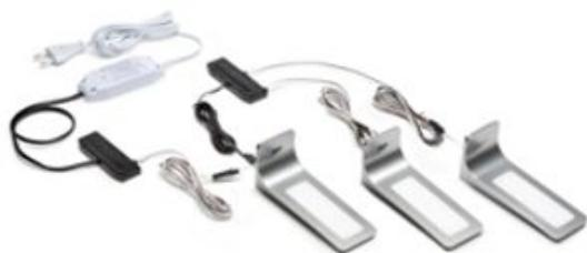
Комплект: 3 светодиодных светильника Skate 3.0 TLDM Set3 арт. 2240919N-2, мощность 3x4Вт, 12В, цвет нерж.сталь, свет натуральный, сенсорный выключатель TOUCH LED MASTER с датчиком касания для включения всей линейки, 3 кабеля 2м с разъемом MiniPlug, трансформатор.
