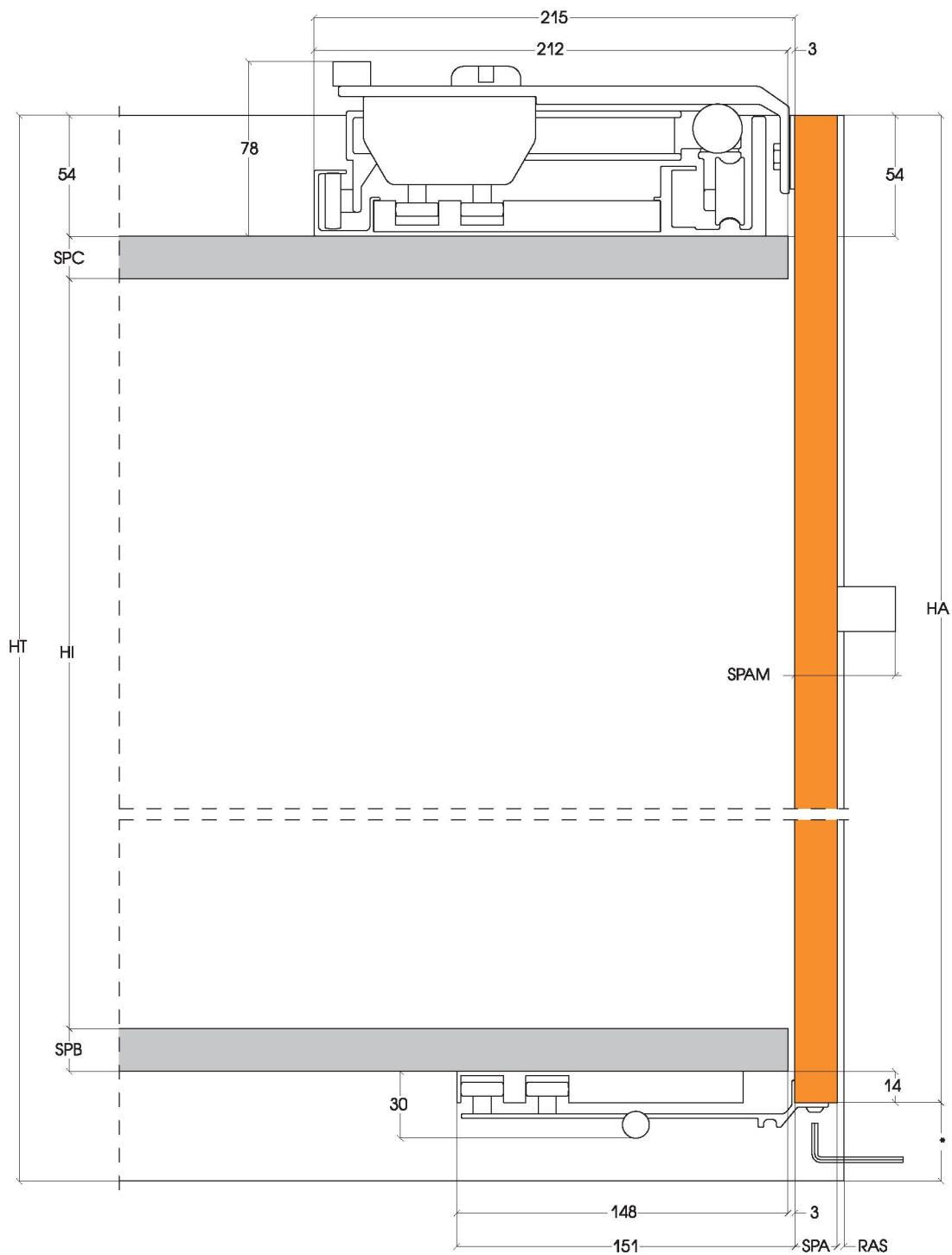
\* Минимальный зазор для монтажа и регулировки 35 мм
