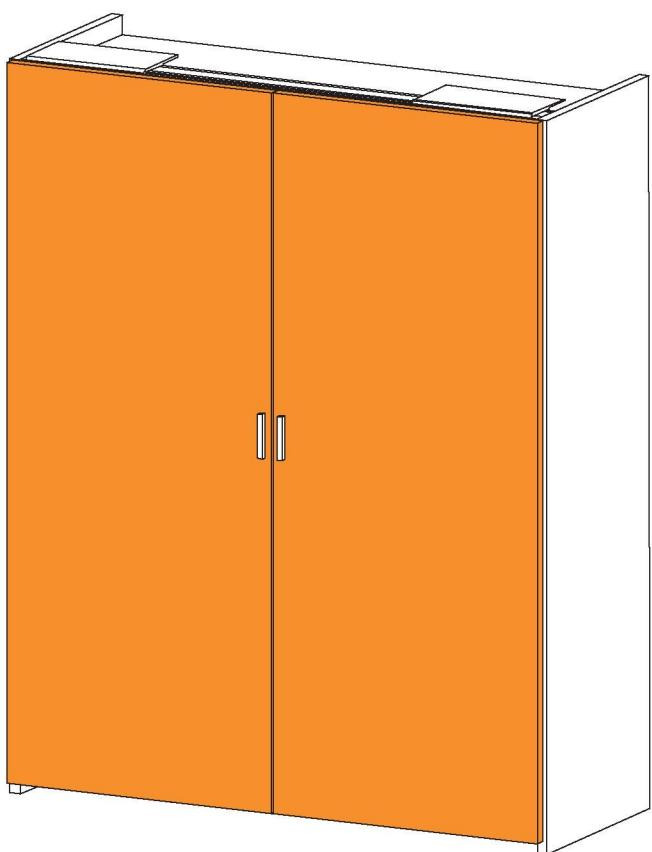
**Тип Б** Система верхних направляющих для вкладных дверей (закрывающих торцы пола и потолка, торцы боковин шкафа - видимые)
