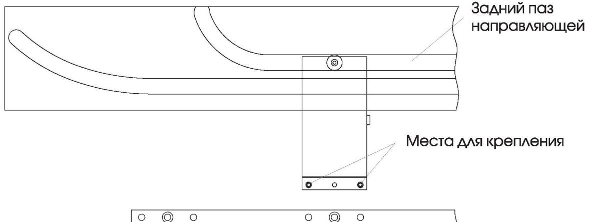
Те же операции повторить с боковой пластиной с роликом, который устанавливается в передний паз нижней направляющей (рис.109).
