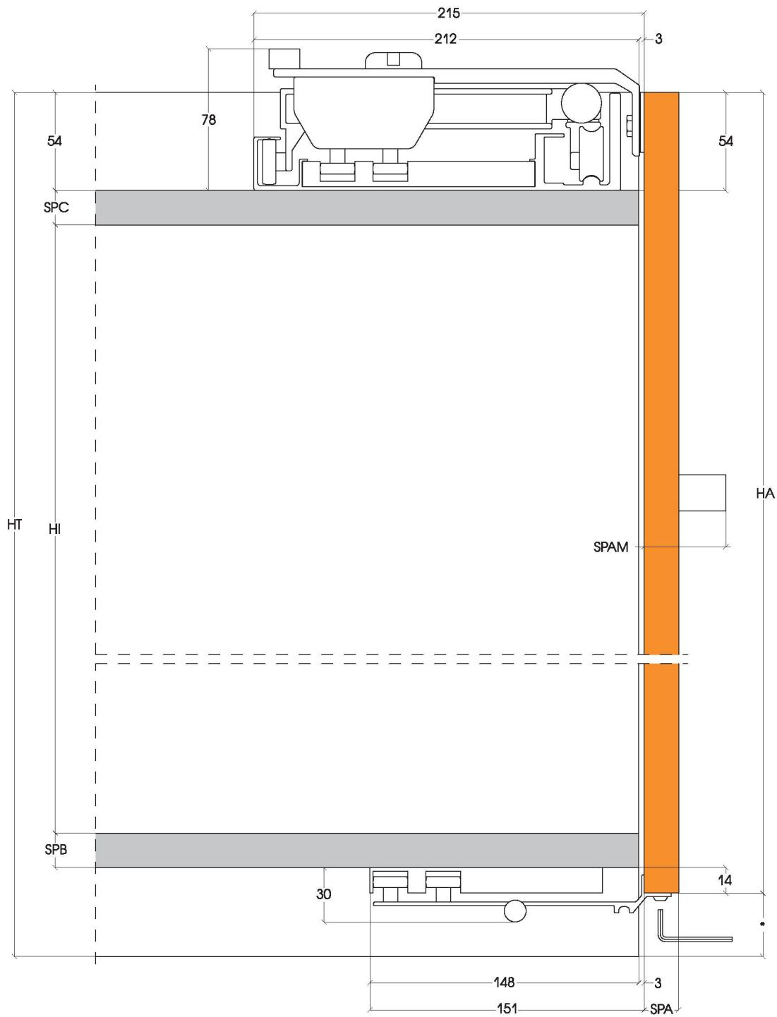
\* Минимальный зазор для монтажа и регулировки 35 мм
