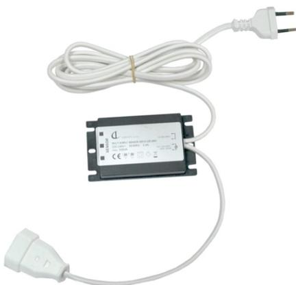
COMBO представляет собой сенсорный выключатель с датчиком приближения со встроенными фотоэлементами. Устройство имеет выход на три светильника (или три комплекта светильников), подключенных к такому же количеству датчиков, которые могут функционировать как отдельно, так и в комбинации друг с другом. COMBO поставляется с входящим кабелем и тремя выходящими кабелями 150мм, оснащенными разъемами MiniPlug. Доступны четыре модели сенсорных датчиков.
