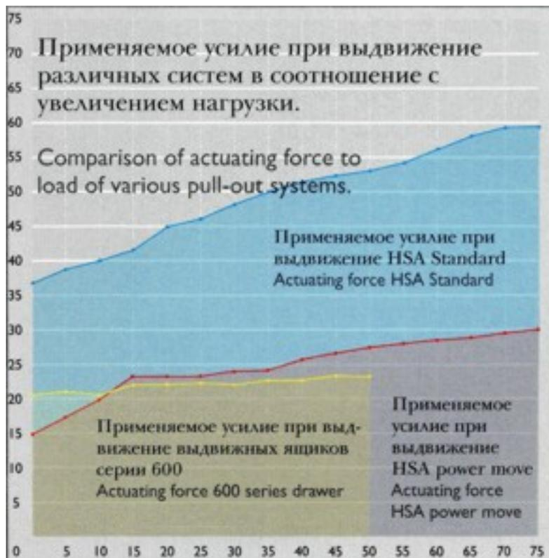
Сравнение усилий при нагрузке у HSA standard и у HSA power move: График указывает, что HSA power move достигает значений, близких к значениям выдвижного ящика серии 600.
